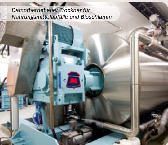
Dampfbetriebener Trockner für Nahrungsmittelabfälle und Bioschlamm
